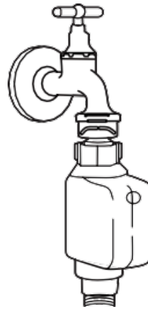
Tilloppsslang med Aqua Stop (säkerhetsventil)
